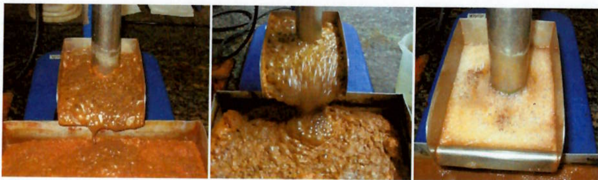
Figura 12 – Etapas Rougher, Cleaner e Scavenger da flotação cruzada.
